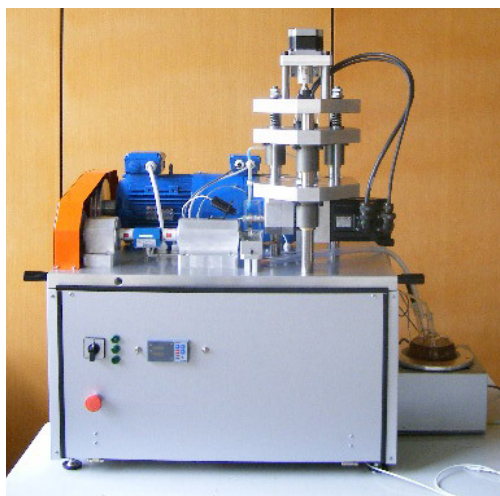
Слика 7. Универзални трибометар „UT-07“, Институт „ТЕКНИКЕР“, Шпанија
