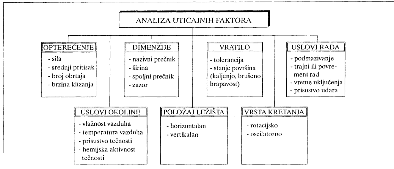
Sl. 2. Klasifikacija uticajnih faktora za ispravnu konstrukciju kliznog ležišta od termoplastičnih masa Classification of influential factors for appropriate construction of the thermoplastics sliding bearing Классификация факторов определяющих качество конструкции подшипника скольжения из термопластичной массы
