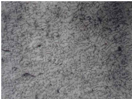
Slika 7 Mikrostruktura navara - austenit sa izlučenim karbidima hroma i niobijuma (200×)
