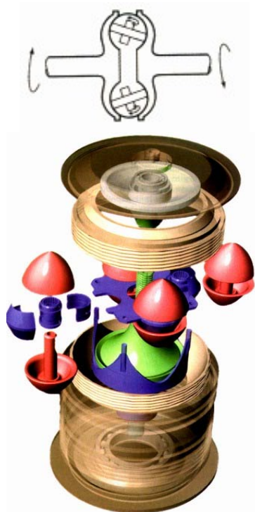
Slika 5a: Varijanta CVT za primenu na kamionima
