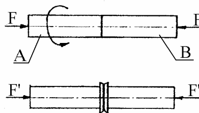
Slika 1. Principijelna šema običnog frikcionog zavarivanja
