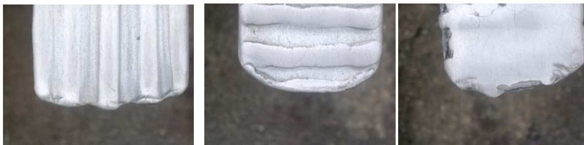
Slika 11: Izgled navarenih zuba posle 3200 h rada
