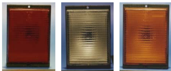
Slika 1. Ispitivani uzorci: a) stop svetlo, b) svetlo hoda u nazad i c) pokazivač pravca
