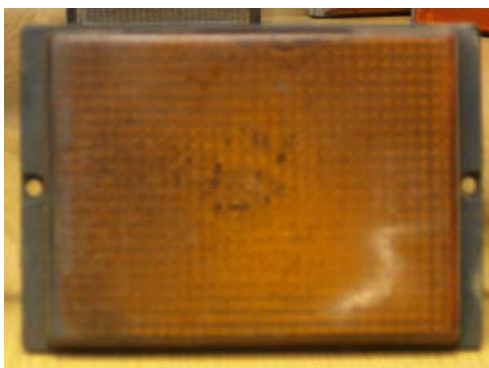
Slika 4. Uzorak 2 – potpuno zaprljan sa vidljivim crnim mrljama
