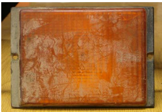
Slika 3. Uzorak 1 – zaprljan sa česticama prašine i sitnim pukotinama u materijalu
