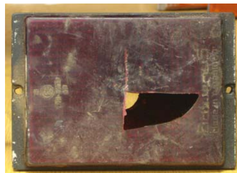
Slika 6. Uzorak 4 – Potpuno mehaničko oštećenje, zamašćenost i vidna promena boje
