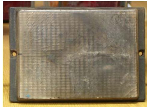
Slika 5 Uzorak 3 – vidljiva oštećenja, naprsline i masnoća u unutrašnjosti transparenta
