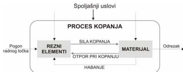
Slika 1. Šema procesa kopanja rotornim bagerima
