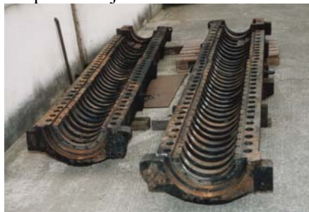
Slika 3. – Oštećena cjedila EP prese
