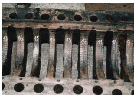
Slika 4.- Oštećenje jarmova po cijelom obodu i izrazito prije noževa čistača
