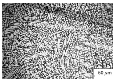
Krupnozrna martenzitna struktura sa karbidima (posle plastične deformacije)
