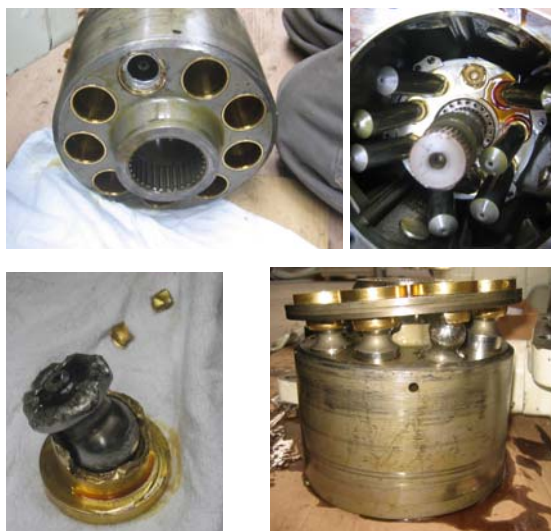
Slika 4. Oštećenja elemenata pumpe br. 2
