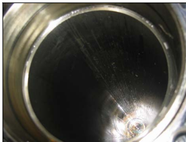
Slika 11. Oštećenja cilindra kopanja
