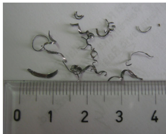
Slika 7. Metalni opiljci pronađeni u filterima fisokog pritiska
