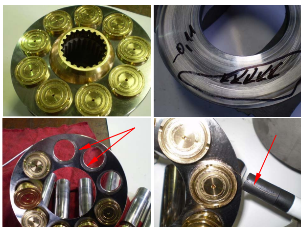
Slika 6. Oštećenja na komponentama pumpe
