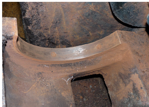
Slika 2. Poluprsten prije demontaže s praškastim talozima nakon ispitivanja uporabom u preši tip EP 16
