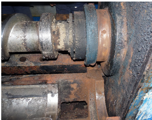
Slika 1. Vrat kućišta reduktora i površine polutke cjedila prije skidanja poluprstena
