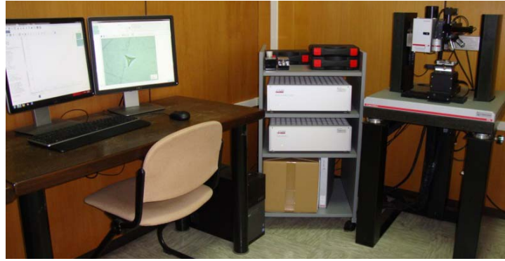
Fig. 2. Anton Paar Nanoindenter [1].
